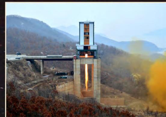
2017年3月18日，新研发的大功率发动机地上点火试验。
